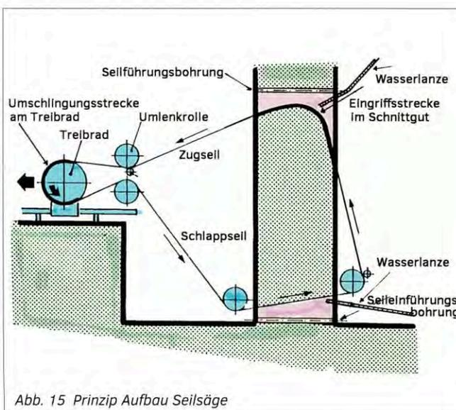
Abb. 15 Prinzip Aufbau Seilsäge
