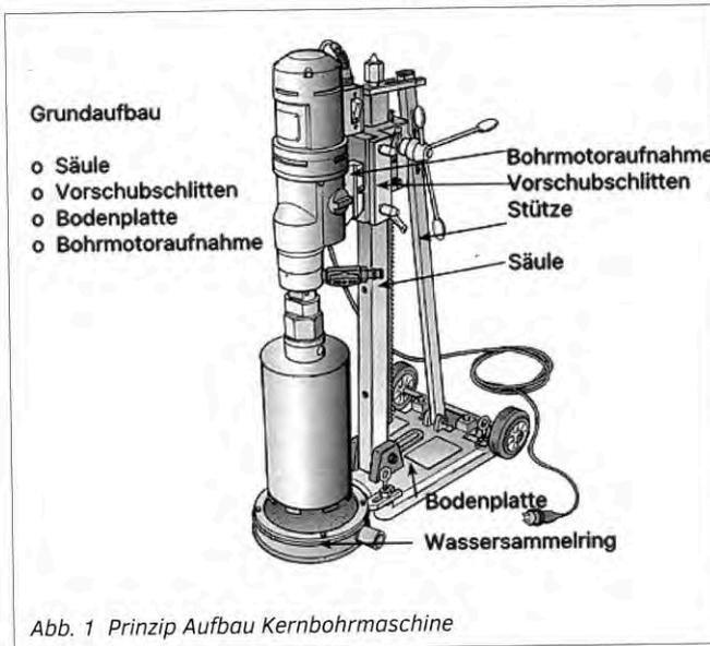
Abb. 1 Prinzip Aufbau Kernbohrmaschine
